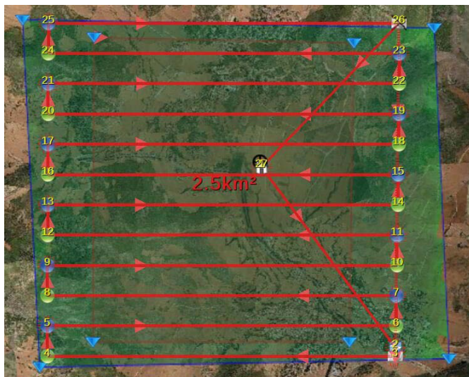
图 6 1:2000 比例尺测图航线设计图
