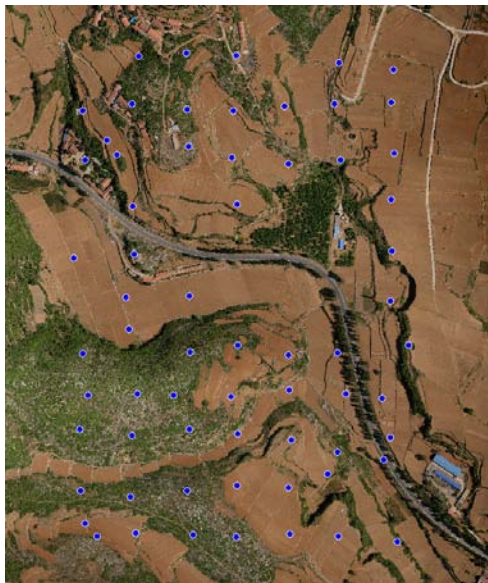
图 15 1:500 比例尺测图检查点位置分布图
