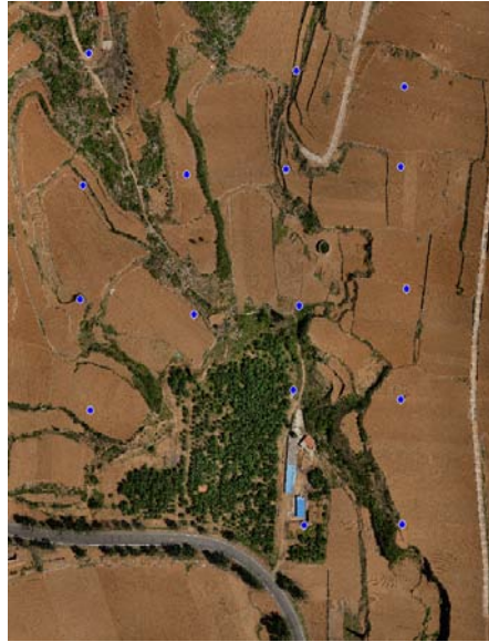
图 21 1.6cm 地面分辨率摄影测量检查点位置分布图
