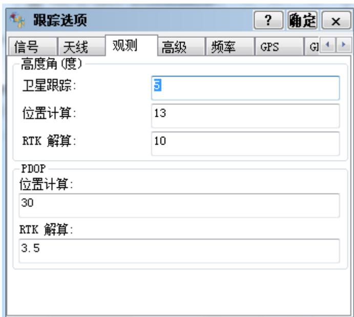
图 3-13 置接收机定位高度角
