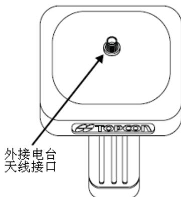
图 1-7 GR-5 仪器壳和外接电台天线接口
