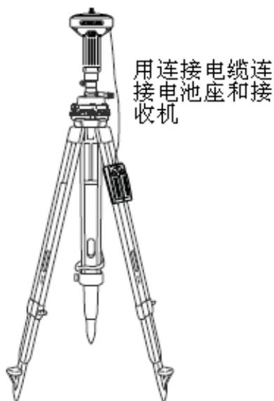
图 2-15 连接电池座和接收机
