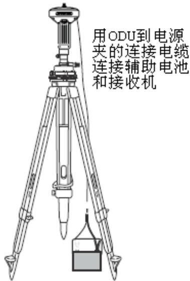
图 2-18 连接辅助电池和接收机
