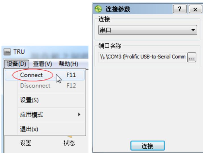
图 2-17 通过串口连接接收机
