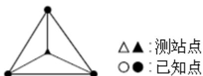
下图所示的图形是无法计算出正确结果的：
