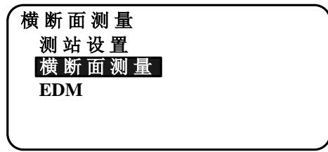
4. 输入横断面测量的线路名称、桩号间距、桩号增量、桩号里程，并选择观测方向，按[确定]键。
