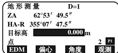
在观测第 2 个点时，如果：(1) 距离测回数设置为 1；(2) 距离读数次数设置为 1；盘左盘右观测设置为否；则显示[偏心]键。按[偏心]键，进入目标点的偏心观测。
