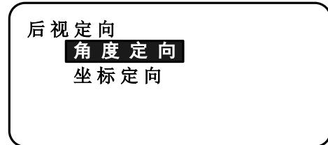
3. 输入已知方向值后，按[确定]键，此时屏幕所显示水平角值即为所输入值。
