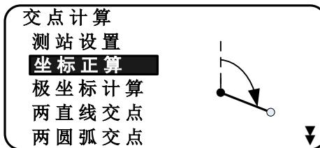
“极坐标计算”: 已知两个已知点(P1、P2)、一个夹角( $T$ , P2 到待求点方位与 P2 到 P1 方位的夹角)、一个在 P2 到待求点方位上的距离, 计算待求点(交点)的坐标。其中, 已知点 P1、P2 的坐标可以调用, 也可以直接观测; 计算出的待求点可以直接进入放样功能。
