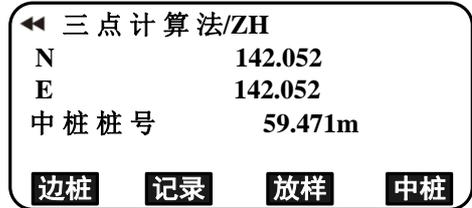
9. 按[中桩]键, 输入中桩桩号, 再按[确定]键, 可以计算线路上任意中桩点的坐标, 并显示计算结果。
