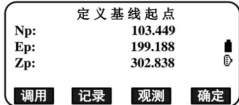
5. 同理，输入基线终点(基线点 2)的坐标数据。
