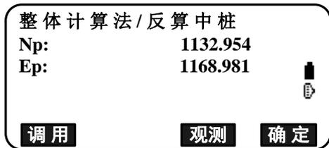
5. 在第 4 步界面按[确定]键，计算并显示对应中桩点的坐标和桩号。
