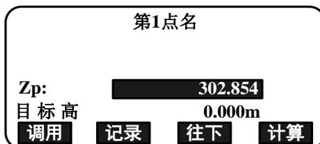
8. 全部已知点观测完毕后，按[计算]键，自动计算测站点高程。屏幕显示测站点坐标及其后方交会精度的标准偏差等数据。
