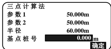
8. 在第7步界面, 按[确定]键, 仪器计算主桩点坐标并显示结果。
