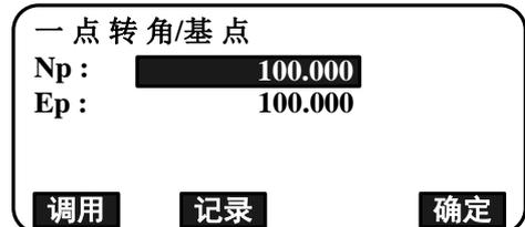
5. 输入曲线参数：曲线方向、转交角、基\_交距、交\_终距、回旋曲线参数 1 (A1)、回旋曲线参数 2 (A2)、圆曲线半径和基点桩号（起始桩号）。
