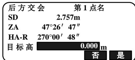
6. 输入第 1 个已知点坐标值，按[往下]键，进入第 2 个已知点界面。
