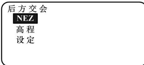
4. 照准第一个已知点，按[观测]键开始测量。屏幕上显示测量结果。
