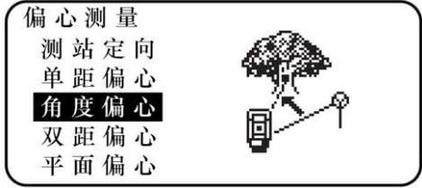
5. 照准偏心点(棱镜点)，按[观测]键开始测量。
