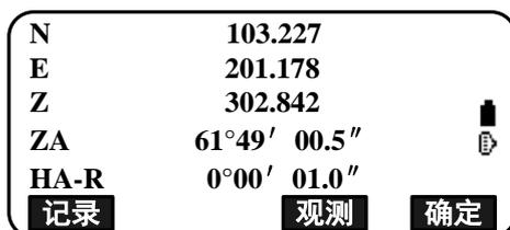
6. 按[确定]键，将测量结果作为第一个点“01”的坐标值。
