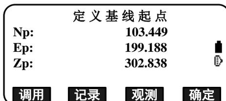
5. 按[确定]键, 采用观测结果作为基线起点的坐标。
