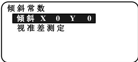
选择“倾斜 XY”，按 {ENT} 键，显示 X 方向（视准轴方向）和 Y 方向（水平轴方向）的倾斜角。
