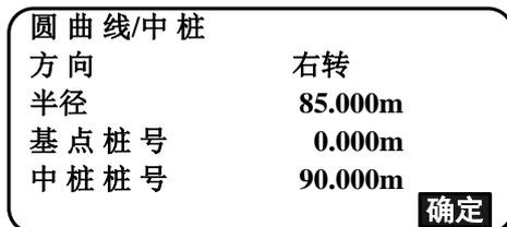
6. 在第 5 步的界面，按[确定]键，计算中桩点的坐标，并显示其坐标和方位角。
