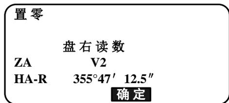
5. 旋转仪器照准部 180°，盘右精确照准同一目标。
