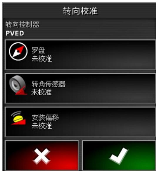
2. 选择**罗盘**。如果组件报告已校准，那么在此车辆上的接收器尚未校准的情况下，仍会完成校准步骤。
