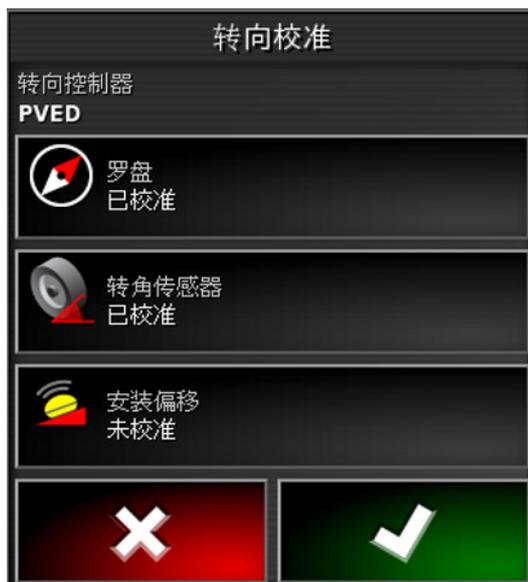
**注意：**要校准安装偏移，请在 70 m/230 ft 上绘制“A”和“B”路线点，沿该路线以 2 kph 或 1.2 mph 的速度驾驶车辆。操作员在路线尽头使车辆转弯，然后重复该步骤。重要的是，车辆应在大约 30 cm 范围内遇到“A”和“B”路点，以启动校准步骤中的下一步。
