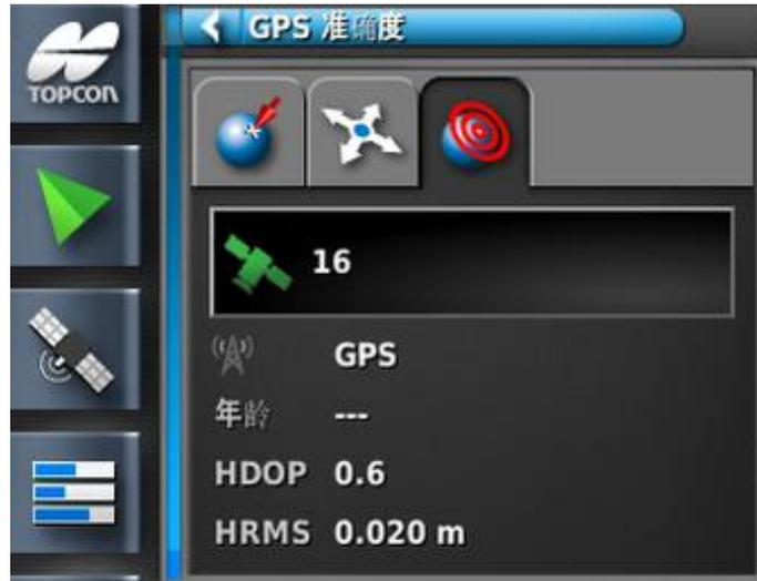
这会显示可用卫星数量、更正时间(秒)、HDOP(较低的值表示准确度较高)和 HRMS(较低的值表示准确度较高)。
