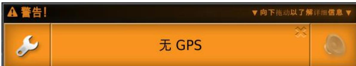
如果警报窗口顶部显示**向下拖动以获得详细信息**,您可以将警报窗口向下拖动,以显示有关警报的更多详细信息。
