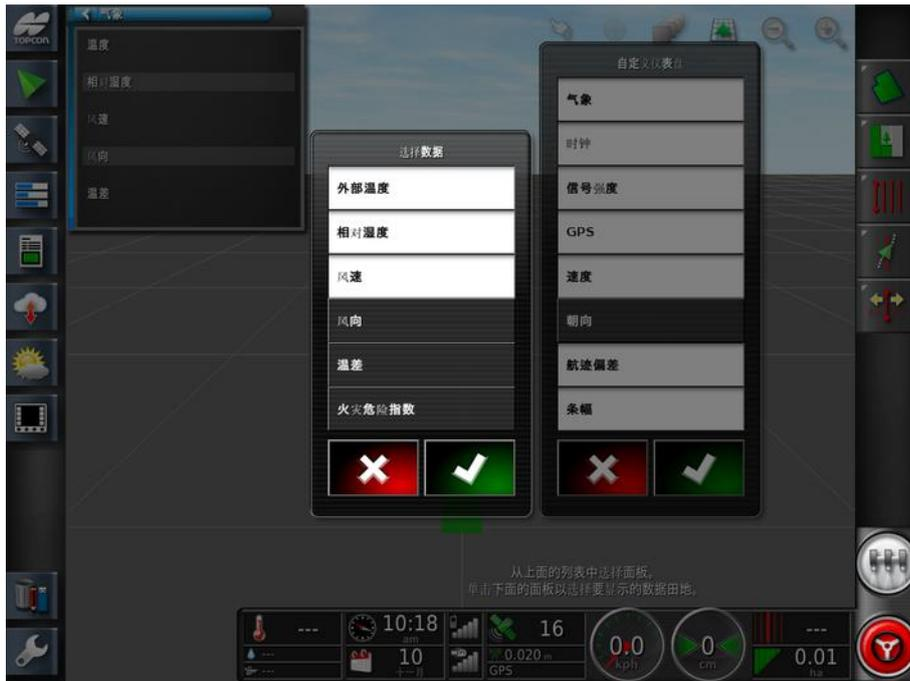
在连接后，迷你视图和仪表盘均可显示温度、相对湿度、风速、风向和温差。
