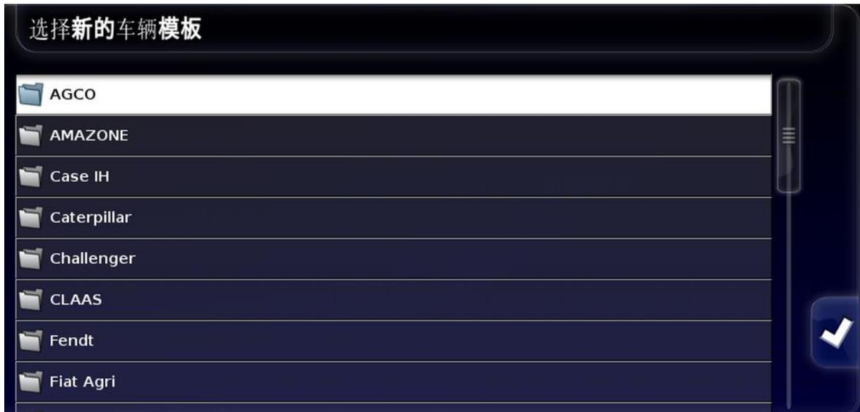
将显示预定义的工厂车辆模块列表。模板包含标准测量值和其中可用的转向参数信息。
