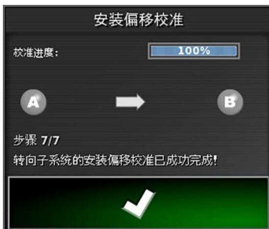
对于罗盘、转角传感器和安装偏移，“转向校准”屏幕将显示已校准。
