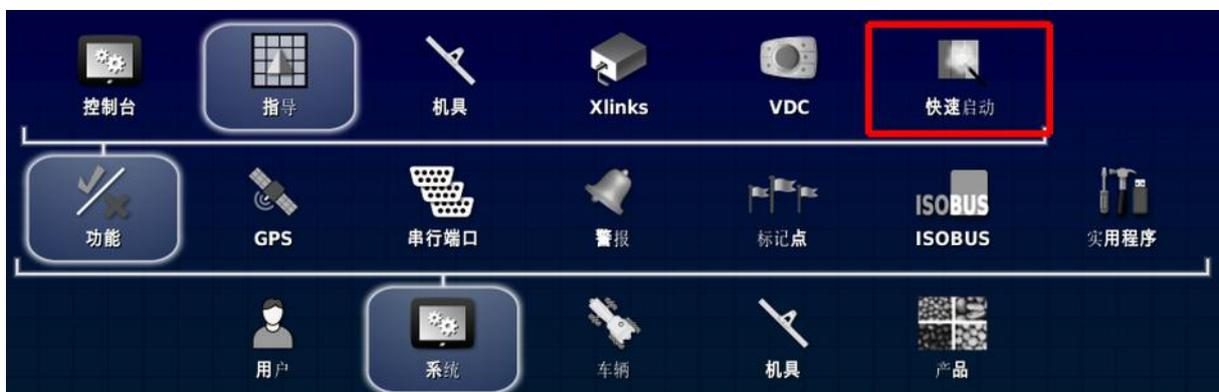
1. 选择**系统/功能/快速启动**。这将显示“快速启动设置”页。此页面可用于选择快速启动将自动逐步执行的任务。启用
