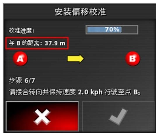
当校准进度栏达到 100% 时，这表示系统已具有关于第二阶段校准的充足数据，此时安装偏移校准将暂停。
