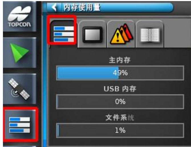
2. 选择**控制台诊断**
