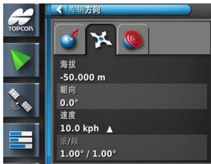
这显示车辆的海拔、方向(度)、实际车速和滚/颠(度)。
