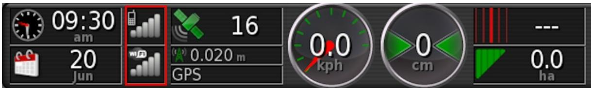
信号强度面板显示 GPRS 和无线信号强度。
