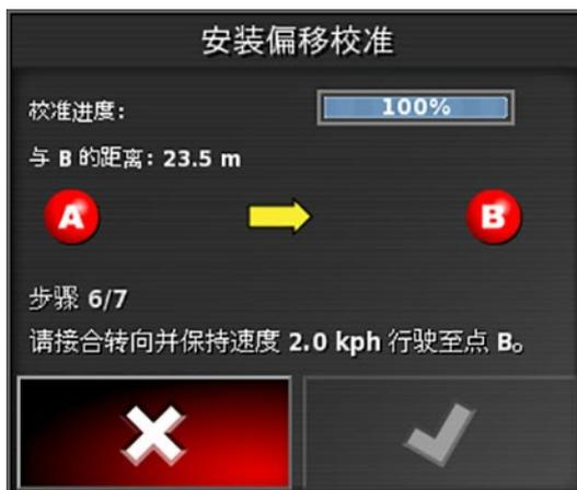
18. 停止车辆。安装偏移已成功校准。
