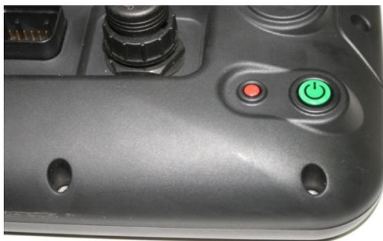
**注意：**红色按钮将重置控制台，因此控制台可能会失去未保存的数据。重置控制台仅在控制台冻结或无法以正常方式关闭的情况下使用。除非存在故障，否则不建议使用重置。
