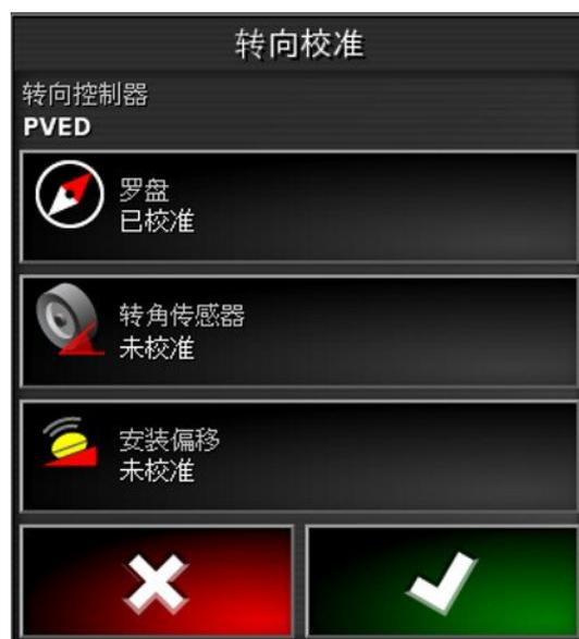
**注意：**屏幕的数目以及屏幕的内容会因车辆和转向控制器类型而不同。如果显示错误，应阅读消息并采取建议的操作，然后再继续。
