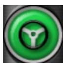
自动转向接合并启用。选择**自动转向接合**以变回手动控制。请注意，在变为绿色之前，此按钮可能会短暂地呈蓝色闪烁。
