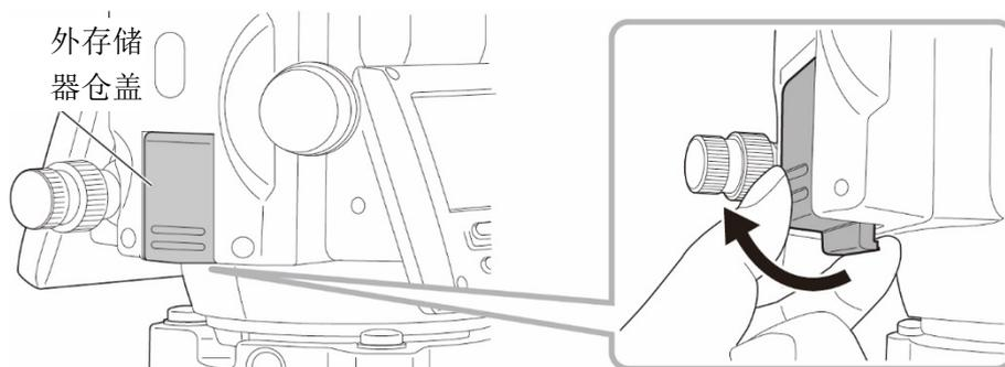
2. 在相应插槽内插入 USB 存储设备。
