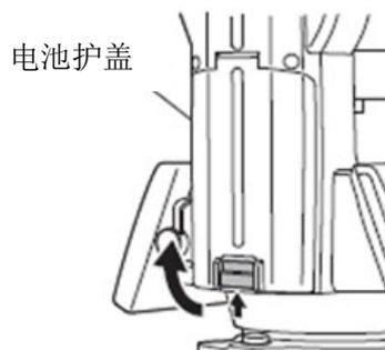
2 沿电池的箭头方向，垂直向下将电池插入。
