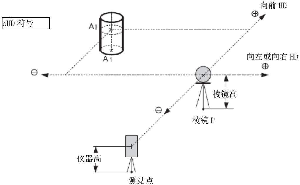
如需测量地面点  $A_1$  的坐标：应输入仪器高/棱镜高。
