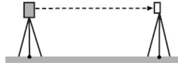
3. 在测量模式下，用盘左位置精确照准目标中心，读取水平角读数 A1 和垂直角读数 B1。
