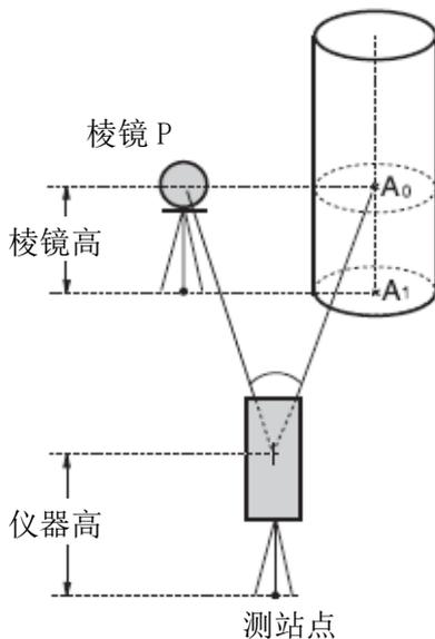
照准  $A_0$  的方法有两种，可选用其中一种，第一种方法是将垂直角锁定到棱镜位置、不因望远镜上下转动而变化；第二种方法是垂直角随望远镜上下转动而变化。在后一种情况下，SD（倾斜距离）和 VD（高差）也将随望远镜的转动而变化。
