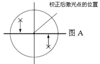
b 轻轻松开上（下）校正螺丝，以同样量旋紧下（上）校正螺丝，直至激光点移至校正靶的水平线上。
