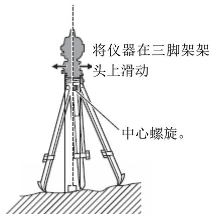
6. 调整旋转脚螺旋 A、B，使 X 轴的倾斜角值为 0。再调整旋转脚螺旋 C，使 Y 轴的倾斜角值为 0。
