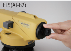
40x 目镜 EL5 (AT-B2) 替换标准的目镜，增大放大倍率到40x。
