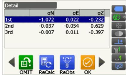
8. 如果某个点的测量结果有问题，将光标移到该点号上，按[忽略]键，则“作废”字样将会显示在这个点号的右侧。
