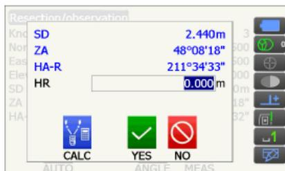
从第 3 个点开始，将会显示[自动]键。按[自动]键将会自动转向下一个点，并自动开始观测。
