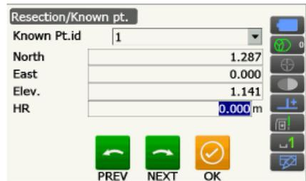
4. 照准第一个已知点，按[观测]键开始测量。
