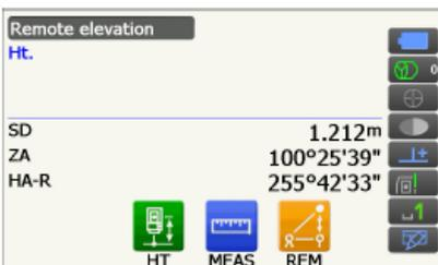
4. 照准待测物体，按[悬高]键，开始悬高测量。显示的“高度”即为被测物体测点至地面的高度。
