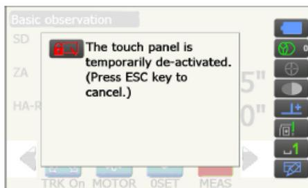
当显示以上信息时，触摸屏将无法操作，按{ESC}键可消除显示的信息并重新开启触摸屏。
