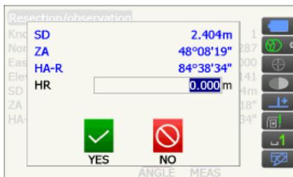
6. 重复步骤 4~5，以同样的方式观测后续各点。当观测的点数满足计算要求时，将会显示[计算]键。
