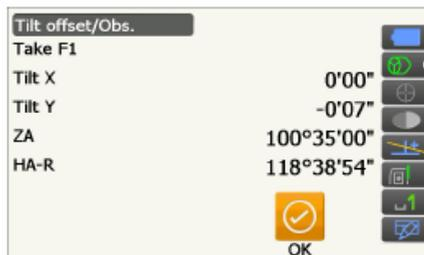
5. 按[OK]键，仪器照准部和望远镜由当前的位置旋转  $180^\circ$ 。
