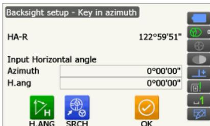
3. 按**[OK]**键设置输入的值，并显示<坐标测量>界面。
