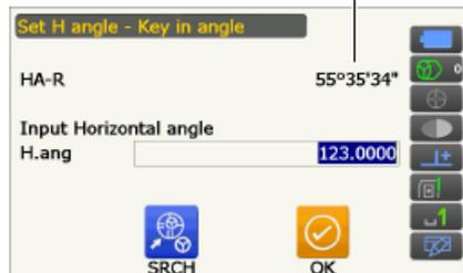
4. 按[OK]键，确认输入的值，并显示新的水平角，
