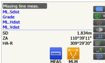
4. 照准下一目标点，按**[对边]**键开始观测，通过对边测量可以确定多个目标点与起始点间的倾斜距离、坡度、水平距离和高差。
