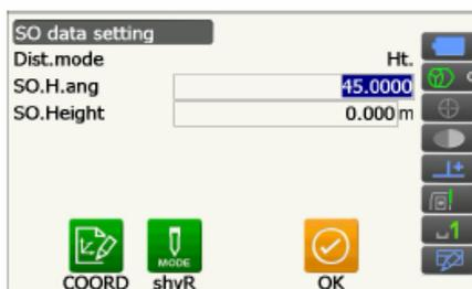
5. 按[H 旋转]键可使仪器自动旋转至放样方向上，此时水平角差值为“0”。
