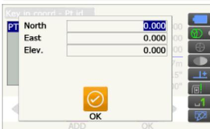
4. 在步骤 3<输入坐标>界面下的放样点名表中选取放样点，按[OK]键进入<坐标放样>界面，屏幕显示指示仪器应转动的方向和角度。
