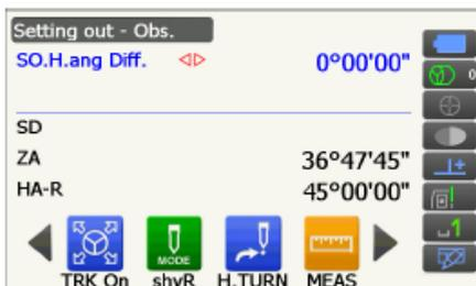
6. 照准棱镜按[观测]键进行距离测量，屏幕上显示出测量结果。
