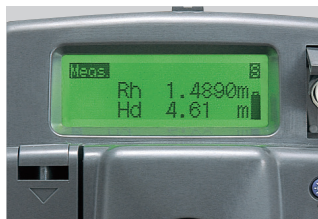
DL-502/503在2.5秒钟之内，自动判读条码标尺的读数，并数字显示观测值。
